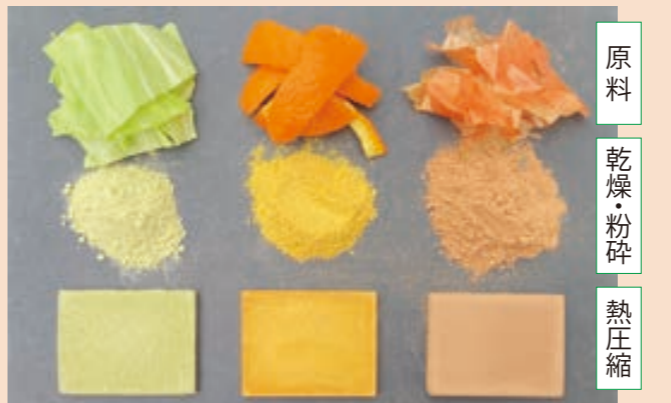
原料となる食品廃棄物を乾燥させ、粉末状にし、その粉末を金型に入れて熱圧縮した100%天然由来の新素材
